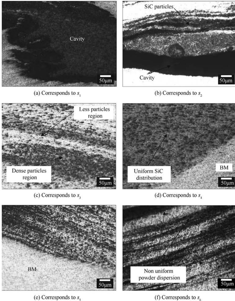
**Fig. 4.** Showing microstructural images of SCs taken at 100 magnifications, (a) corresponds to  $S_1$ ; (b)  $S_2$ ; (c)  $S_3$ ; (d)  $S_4$ ; (e)  $S_5$ ; (f)  $S_6$ .
